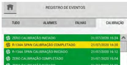
O registro “Calibração” mostra uma lista de tentativas de calibração para o dispositivo.
