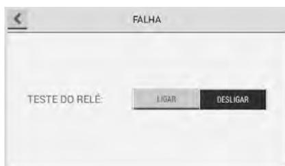
A configuração padrão para o relé de falha interno é sob corrente. Para testar o relé, faça o seguinte:
