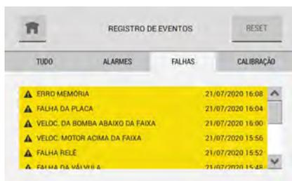
Erros podem ser confirmados e resetados pela janela pop-up, se for um erro relacionado a canal.
