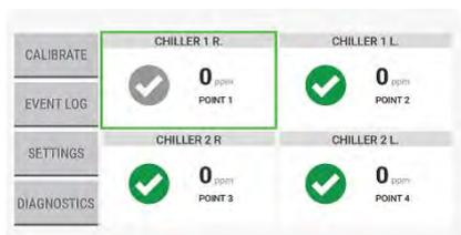
Se for selecionado "Fechar", uma marca de seleção cinza no painel identifica os locais que foram afetados pela calibração sem sucesso. As leituras de gás para esses locais de amostragem ficam abaixo do limite de alarme, mas podem não ser totalmente exatas.
