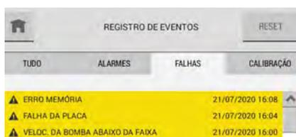
O registro “Falhas” mostra uma lista de todos os eventos de falha para o dispositivo.
