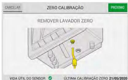
(7) Desconecte o tubo do lavador de gás zero da porta de calibração.
