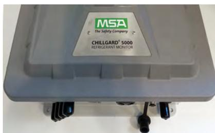
(5) No fundo do dispositivo, instale a tampa na porta de calibração.
